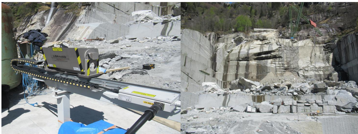
Figura 5: Fotografia del sistema di monitoraggio LiSAmobile impegnato nella campagna di monitoraggio delle pareti della cava Bort nel Comune di Formazza (VB), a sinistra; Fotografie delle pareti centrale ed occidentale della cava Bort con la zona centrale interessata dal crollo spontaneo dell'Aprile 2022 e oggetto di monitoraggio, a destra.
